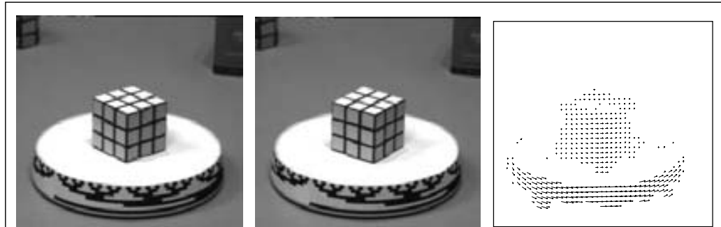
Figura 24.7 (a) Un cubo de Rubik en una mesa rotatoria. (b) El mismo cubo, mostrado 19/30 segundos después. (Cortesía de Richard Szeliski.) (c) Vectores de flujo calculados comparando las dos imágenes de (a) y (b). (Cortesía de Joe Weber y Jitendra Malik.)
